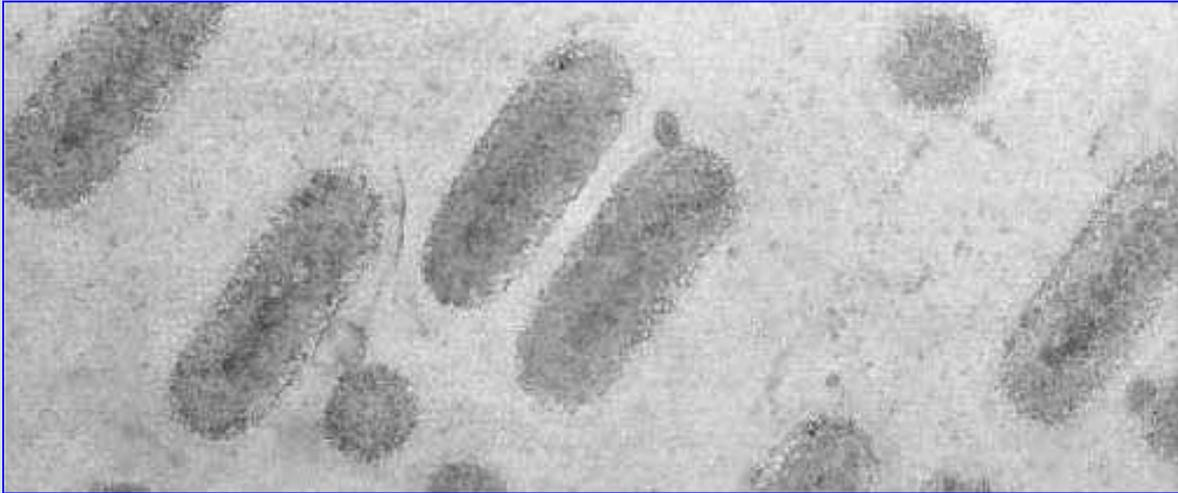
Marques formées dans une couche bi-matériau de type Silicium / Alliage Cuivre sur un BD-R inorganique TDK (document TDK / image microscope électronique à transmission)
